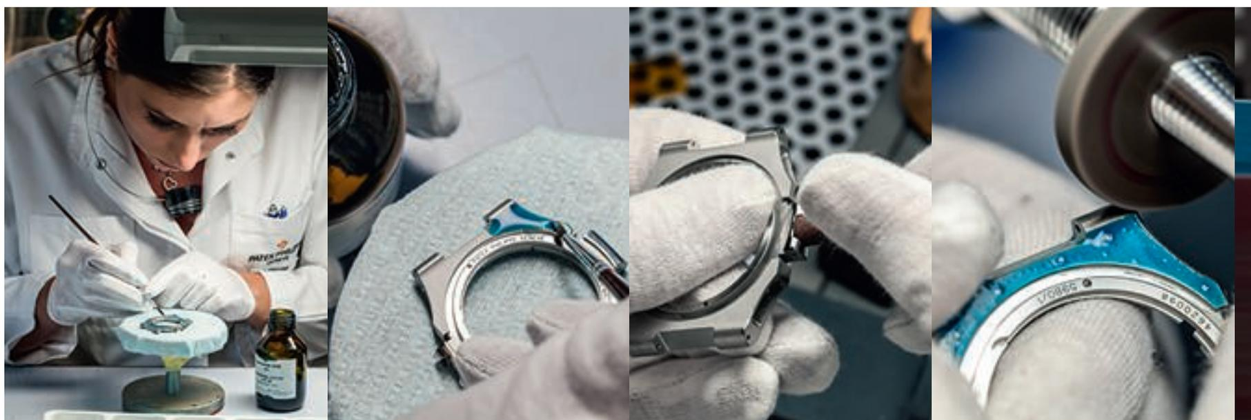
上，然后插进销针连接每个链节，再利用一种样子古怪的工具固定位置，而边缘则经过打磨平滑。然后，再次开展打磨工作，这次是整条表链，确保所有经抛光、缎纹处理的表层平整光滑，还要打磨斜角边缘。每个步骤都必须精确无误地执行，即使是上胶纸也不例外。例如，开孔的胶纸在覆盖经磨砂处理的“外侧”链节时必须分毫不差，确保“内侧”链节可以得到打磨，然后用沾满钻石磨砂膏的软棉圆盘擦拭光亮，但又不会影响外侧链节的磨砂效果。这样，表壳的工艺处理立时显得更为简单，却又更复杂：简单是因为只有3个部件；复杂则是因为这3个部件须要经过数十道独家打磨工序。
